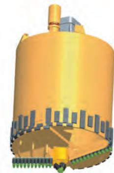
Bucket da roccia SRB-DG35 a doppia lama serie pesante. Utilizzata per stratificazioni rocciose medio-tenere scarsamente fratturate associate a terreno a grana grossa; stratificazioni rocciose dure altamente fratturate e stratificazioni rocciose composite.
